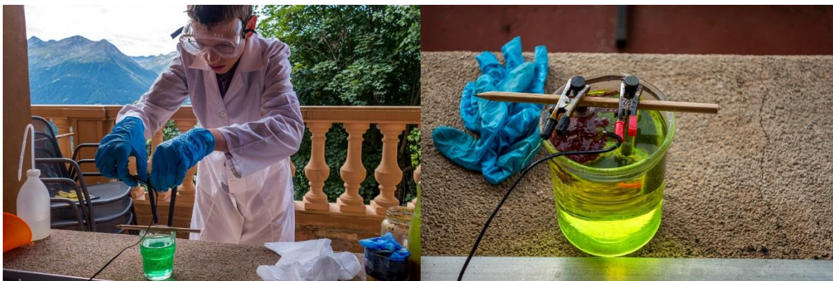
A gauche : introduction des électrodes en graphite dans la solution. A droite : électrolyse du cuivre en cours. On voit une masse rouge de cuivre collée à la cathode.
