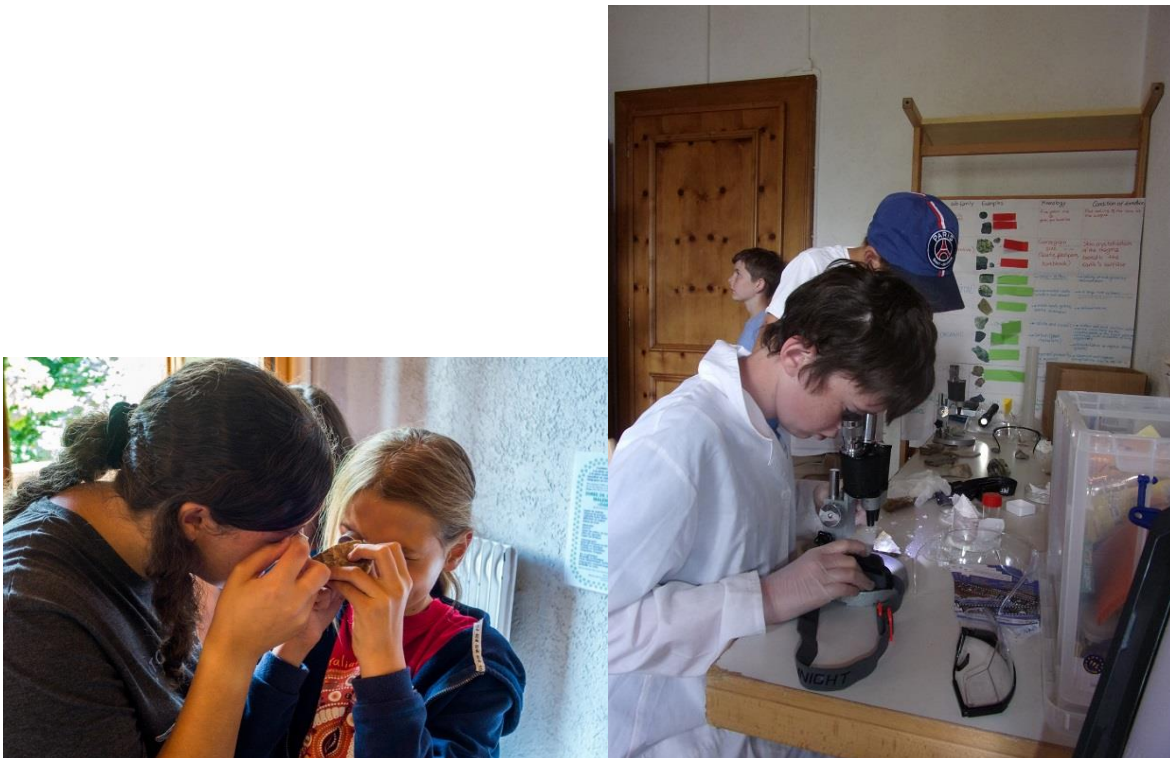
A gauche : Observation des échantillons à la loupe de terrain. A droite : vérification de la pureté des concentrés de chalcopryrite, malachite/azurite et galène à la loupe binoculaire.
