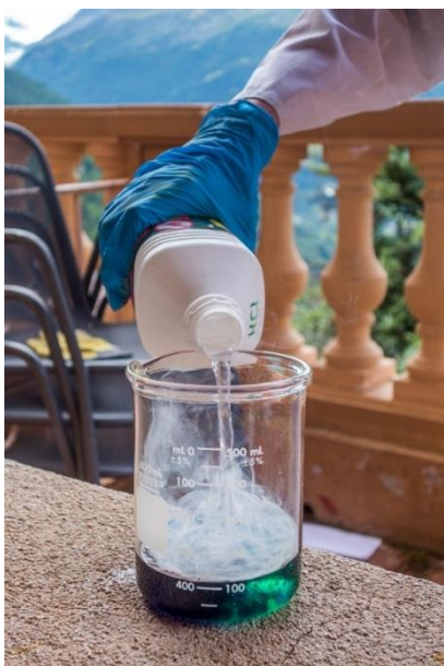
Destruction des complexes aminés par ajout d'acide chlorhydrique.
