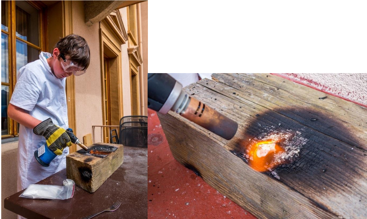
Fusion du Cuivre au chalumeau.
