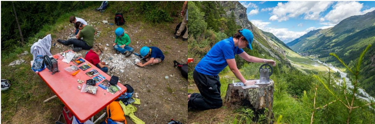
A gauche : Concassage au marteau et tri manuel au bord du chemin menant à la mine de La Lée. A droite : utilisation de la broyeuse à mâchoire.
